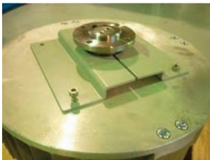
VIS M8x25 TCH INOX (déjà présente sur le moteur) ROND. GROWER D.8 (déjà présente sur le moteur)
